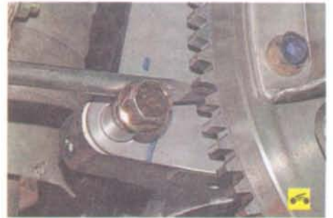
Так расположены болты крепления кожуха сцепления к маховику двигателя.
