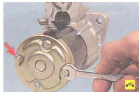
4. ...и снимите тяговое реле.
