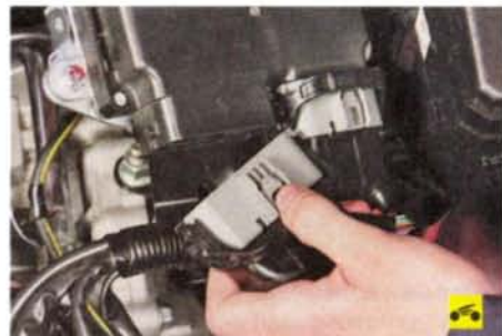
8. ...и отсоедините колодку жгута проводов от разъема «L» блок управления двигателем.
