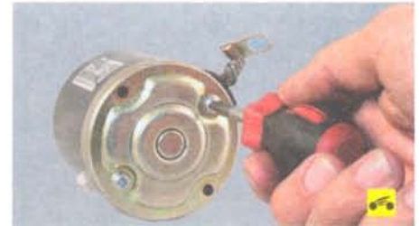
7. Выверните два винта крепления к статору крышки со стороны коллектора...
