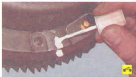
Так расположены болты крепления кожуха сцепления к маховику двигателя.
