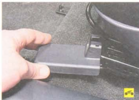
2. Сдвиньте сиденье до упора назад, снимите пластмассовую накладку...
