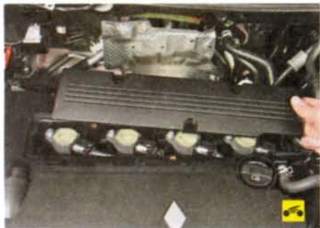
3. ...и снимите крышку.
