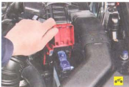
4. Откройте защитную крышку клеммы «плюс»...
