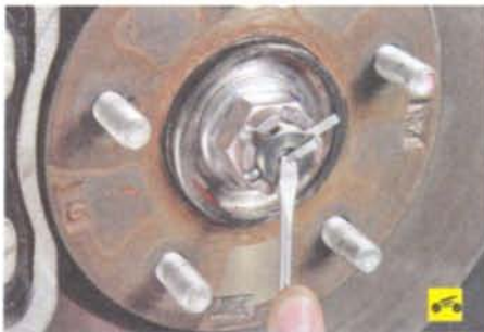
4. Разогните усики шплинта гайки ступицы...
