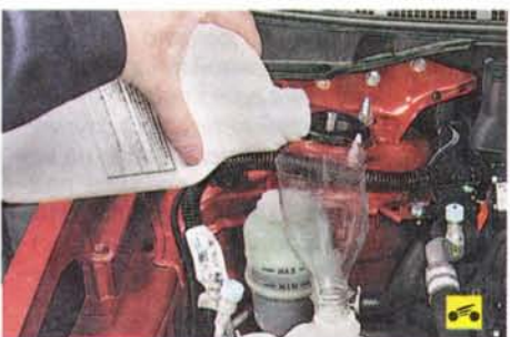
4. ...и откройте крышку расширительного бачка.
