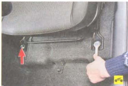
3. ...выверните болты крепления направляющих салазок и снимите болты с пружинными шайбами.
