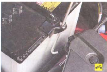
10. ...выведите стяжки из отверстий полки крепления аккумуляторной батареи...
