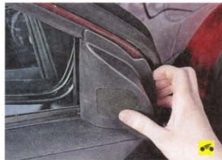
2. Преодолевая сопротивление пластмассовых держателей...
