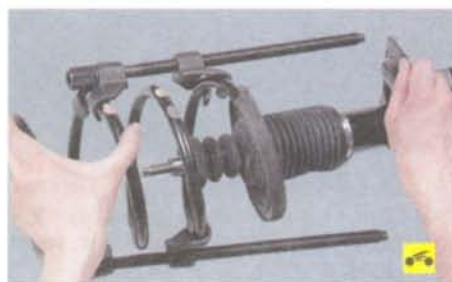
Рис. 7.2. Детали передней амортизаторной стойки: 1 – верхняя опора стойки; 2 – защитный чехол; 3 – верхняя опорная чашка пружины; 4 – амортизатор; 5 – пружина
