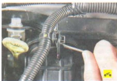
Рис. 5.16. Порядок выворачивания болтов крепления впускного коллектора
