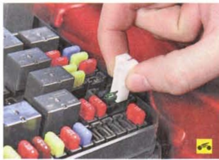
5. Зацепите пинцетом предохранитель...
