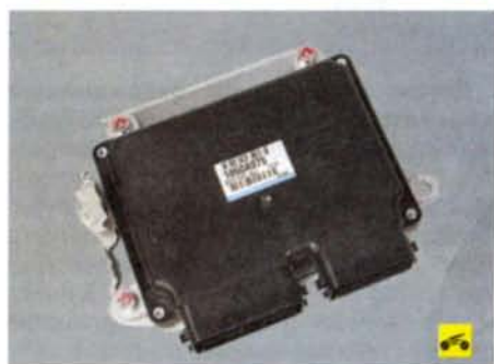
5. Приподнимая вверх блок управления двигателем...
