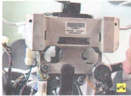
11. Выверните два болта крепления подрулевых переключателей передач...
