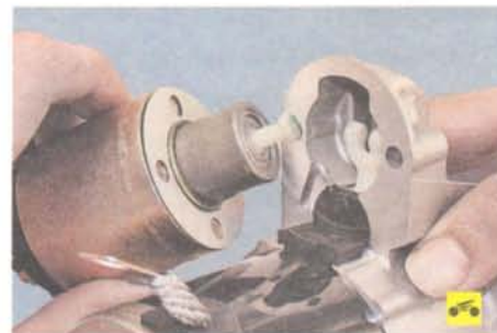
4. ...и снимите тяговое реле.
