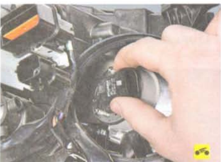
5. Аккуратно поверните лампу против часовой стрелки на 90°...
