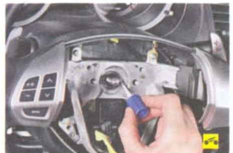
8. ...окончательно отверните гайку крепления рулевого колеса...
