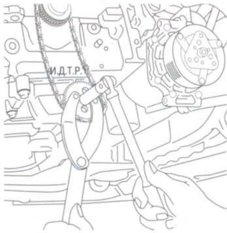
Рис. 5.37. Снятие звездочки привода масляного насоса
