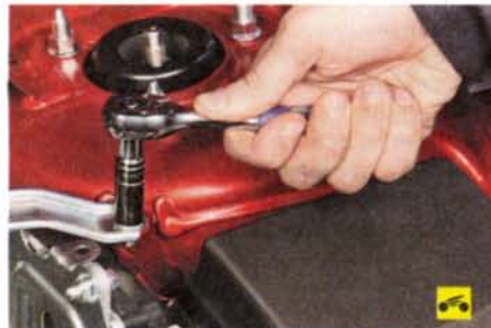
3. Выверните болт крепления верхнего кронштейна блока управления к кузову...
