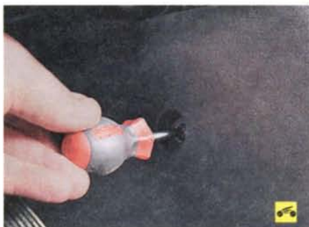
18. ...и один винт крепления к переднему кронштейну на кузове...
