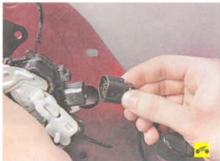
13. ...отсоедините колодку жгута проводов от разъема привода блокировки замка...
