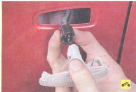
3. ...и отсоедините колодку жгута проводов от выводов патрона лампы.
