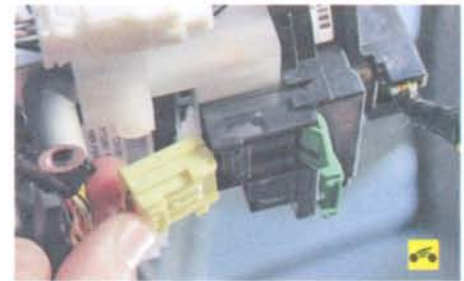
18. ...и отсоедините колодку от контактного кольца.
