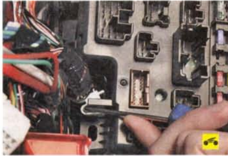
6. Освободите из крепления жгут проводов, отжав отверткой фиксатор.
