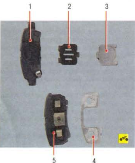
Так выглядят тормозные колодки заднего рабочего тормозного механизма:
