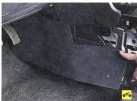
19. ...а затем, преодолевая сопротивление пластмассовых держателей, снимите левую боковую облицовку тоннеля пола.
