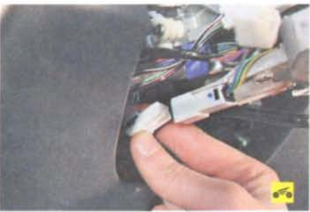
9. ...извлеките переключатель из соединителя и отсоедините от него колодку жгута проводов.
