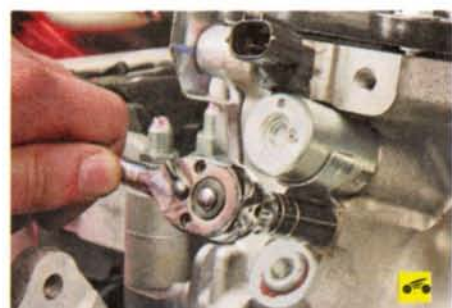
4. Выверните болт крепления управляющего клапана впускного распределительного вала...
