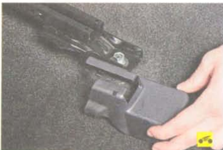
5. ...и правую накладку салазок и выверните задние болты крепления направляющих салазок.
