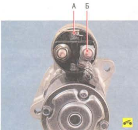
3. Соедините проводами для «прикуривания» клемму «минус» снятой с автомобиля аккумуляторной батареи с корпусом стартера. Вторым провод подсоедините одним концом к клемме «плюс» аккумуляторной батареи, а другим — к выводу А управляющего провода тягового реле. Если тяговое реле исправно, то раздается щелчок и выдвинется муфта привода. В противном случае тяговое реле подлежит замене.
