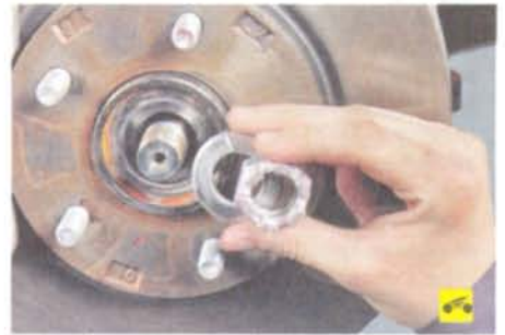
12. Отверните гайку ступицы и снимите гайку и пружинную шайбу.
