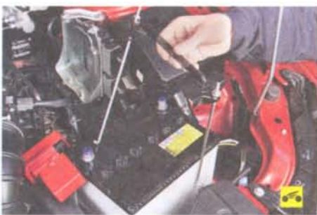
10. ...выведите стяжки из отверстий полки крепления аккумуляторной батареи...
