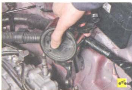
13. ...и снимите левую опору с автомобиля.
