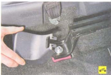
4. Сдвиньте сиденье до упора вперед, снимите левую пластмассовую накладку...
