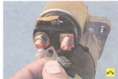
2. ...и отсоедините от него вывод щеткодержателя.
