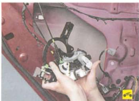
14. ...отсоедините от замка тяги внутренней ручки и снимите замок задней двери с автомобиля.
