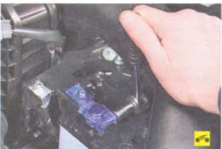
6. Ослабьте затяжку гайки стяжного болта наконечника силового провода...
