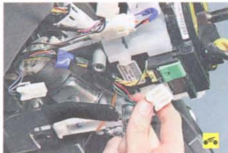
14. ...и отсоедините колодку от разъема контактного кольца.
