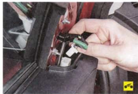
4. Разъедините колодку жгута проводов зеркала.
