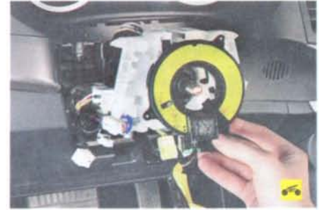
19. Выверните два винта крепления контактного кольца к соединителю подрулевых переключателей...
