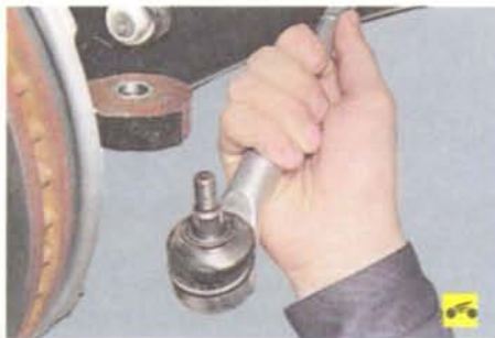
9. Отсоедините рулевую тягу от рычага поворотного кулака (см. «Замена наружного наконечника рулевой тяги», с. 159).
