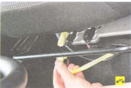
5. ...и правую накладку салазок и выверните задние болты крепления направляющих салазок.
