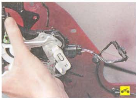
12. Извлеките замок через технологическое отверстие во внутренней панели двери...
