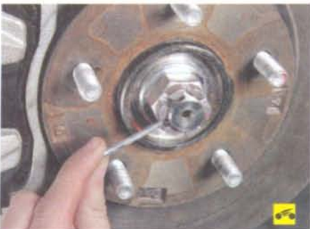
5. ...и извлеките шплинт из отверстия оси поворотного кулака.
