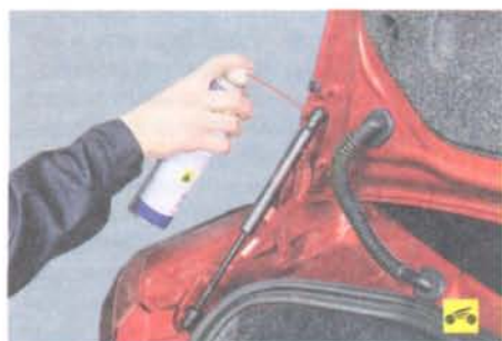
10. Шарниры упоров крышки багажника (силиконовая смазка или ВТВ-1 в аэрозольной упаковке).
