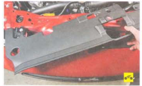
9. Снимите верхнюю декоративную панель бампера (см. «Снятие, разборка и установка переднего бампера», с. 230).
