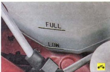
2. Уровень охлаждающей жидкости должен быть между метками «FULL» и «LOW», нанесенными на стенку расширительного бачка.
