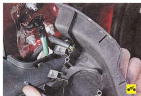
3. ...снимите декоративную заглушку и отсоедините колодку жгута проводов динамика.
