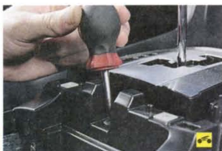
14. Выверните два винта переднего крепления облицовки тоннеля пола...
