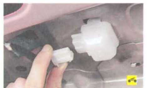
1. Нажмите на фиксатор колодки жгута проводов...
