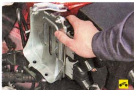
5. Приподнимая вверх блок управления двигателем...
