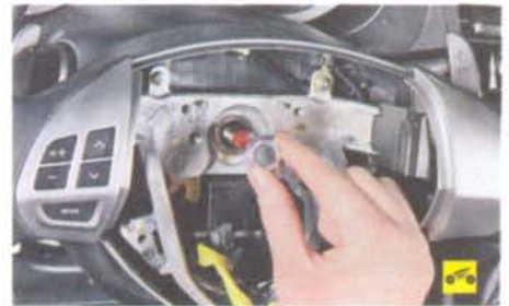
8. ...окончательно отверните гайку крепления рулевого колеса...
