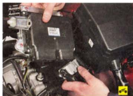
9. Аналогично отсоедините колодку от разъема «R» и снимите блок управления двигателем.
