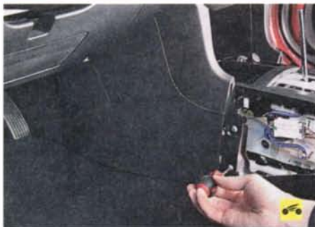
17. Выверните два винта крепления левой боковой облицовки тоннеля пола к центральному кронштейну на кузове...
