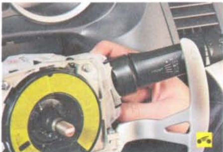
8. Сожмите фиксаторы правого переключателя щеток очистителя и омывателя ветрового стекла...
