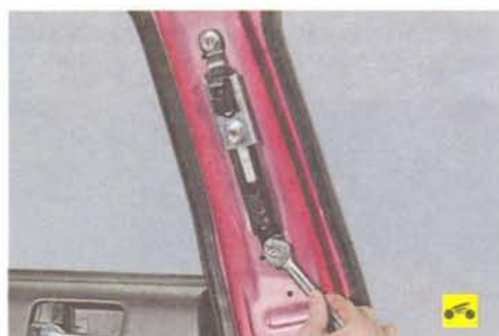
12. Выверните два болта крепления узла для регулировки положения ремня по высоте...
