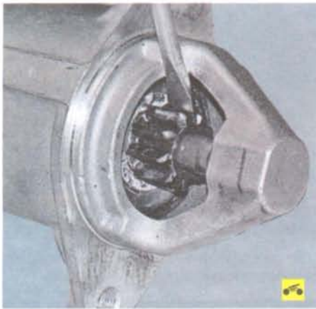
2. Проверните шестерню муфты привода. Шестерня должна легко проворачиваться относительно ступицы муфты в направлении вращения якоря и не должна проворачиваться в противоположном направлении.
