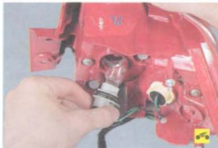
3. ...и выньте его из фонаря вместе с лампой.
