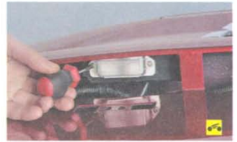
1. Выверните два винта крепления плафона освещения номерного знака.
