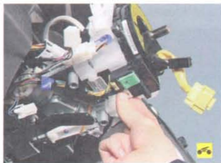
13. Нажмите на фиксатор белой колодки жгута проводов контактного кольца...
