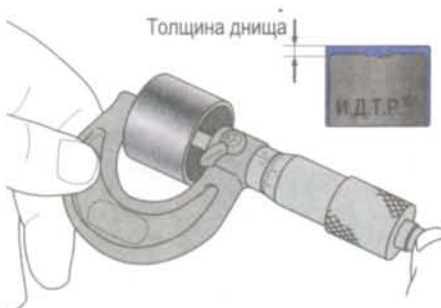
Рис. 4.3. Измерение толщины днища толкателя клапана
