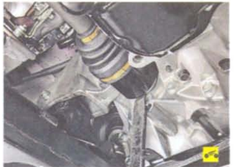
14. С помощью монтажной лопатки выпрессуйте хвостовик внутреннего шарнира из шестерни полуоси дифференциала...
