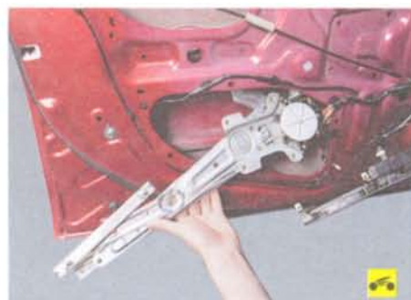
5. ...и извлеките стеклоподъемник из полости двери через монтажное отверстие в ее внутренней панели.
