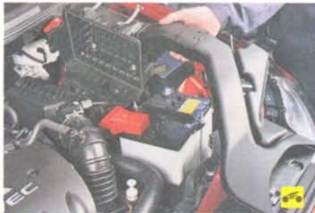
4. Снимите воздушный фильтр (см. «Снятие и установка воздушного фильтра», с. 115).
