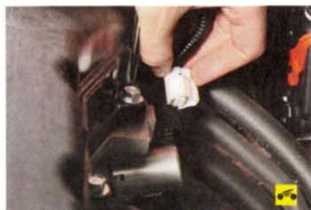
3. ...и отсоедините колодку жгута проводов системы управления двигателем от управляющего клапана механизма изменения фаз выпускного распределительного вала.
