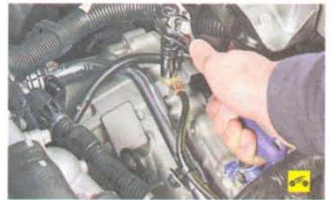
10. Выверните болт крепления «массового» провода к кронштейну трубки системы охлаждения.
