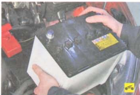
5. Снимите аккумуляторную батарею (см. «Снятие и установка аккумуляторной батареи», с. 187)...
