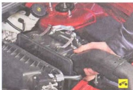
8. Снимите левую часть корпуса воздушного фильтра вместе с воздухоподводящим патрубком (см. «Снятие и установка воздушного фильтра», с. 115).
