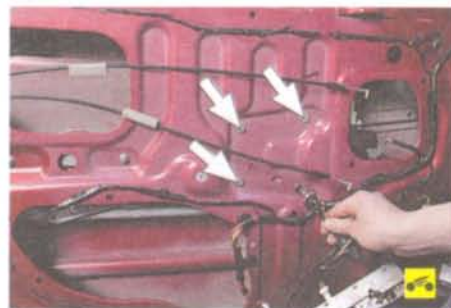
4. Выверните четыре болта крепления моторредуктора стеклоподъемника...
