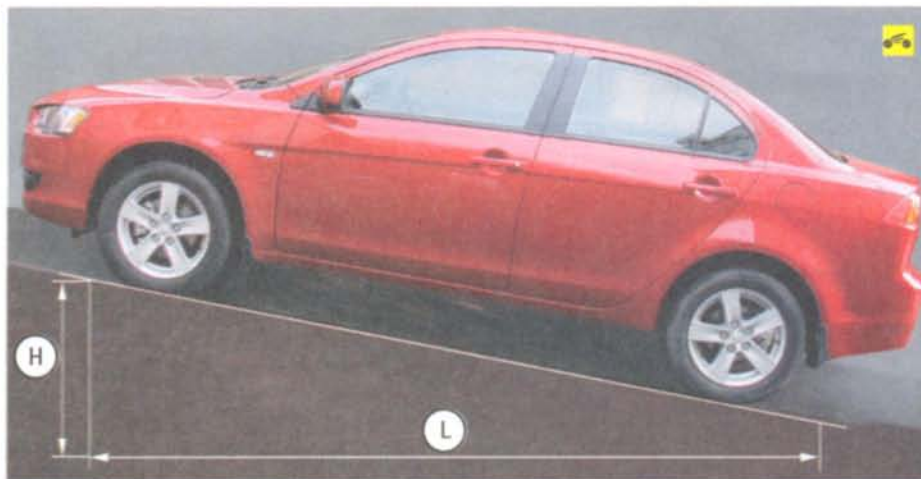
Рис. 4.10. Проверка стояночного тормоза
