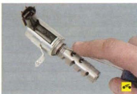
5. ...и выньте клапан из головки блока цилиндров.
