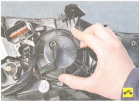
1. Поверните крышку фары против часовой стрелки...
