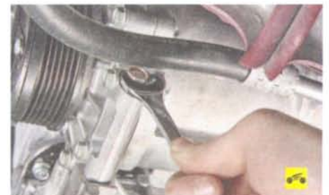
Рис. 5.10. Порядок затяжки болтов крепления крышки головки блока цилиндров
