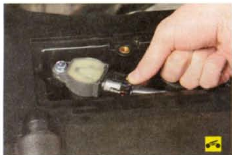
4. Нажмите на фиксатор колодки жгута проводов...
