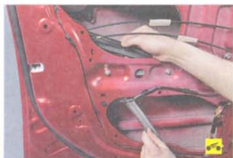
8. ...извлеките из полости двери уплотнительную резиновую ленту...
