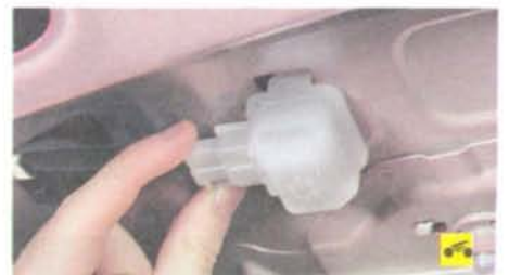
1. Нажмите на фиксатор колодки жгута проводов...
