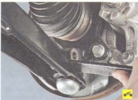
10. Придерживая от проворачивания палец верхнего шарнира стойки стабилизатора, отверните гайки крепления стоек и отсоедините верхние шарниры стоек стабилизатора от кронштейнов амортизаторных стоек (см. «Замена деталей стабилизатора поперечной устойчивости передней подвески», с. 145).
