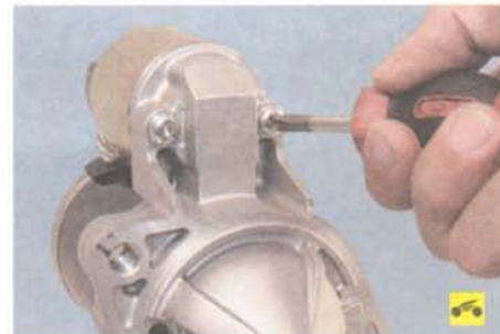
3. Выверните два винта крепления тягового реле к крышке стартера со стороны привода...
