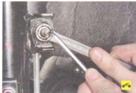
10. Придерживая от проворачивания палец верхнего шарнира стойки стабилизатора, отверните гайки крепления стоек и отсоедините верхние шарниры стоек стабилизатора от кронштейнов амортизаторных стоек (см. «Замена деталей стабилизатора поперечной устойчивости передней подвески», с. 145).
