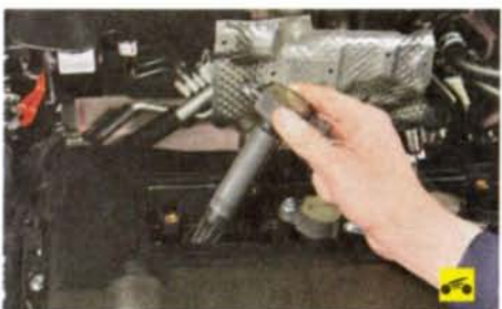
7. ...и снимите катушку зажигания с автомобиля.
