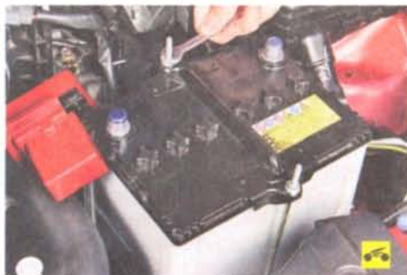
9. Ослабьте затяжку гаек стяжек планки аккумуляторной батареи...
