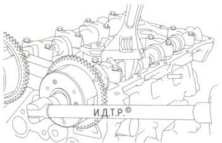
Рис. 5.19. Выворачивание болта крепления муфты распределительного вала впускных клапанов
