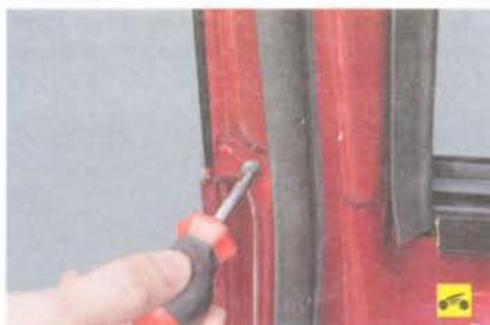
11. ...выверните винт крепления наружного уплотнителя...
