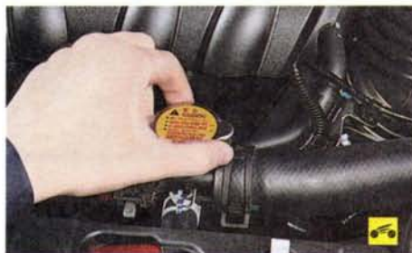
1. Расширительный бачок установлен в подкапотном пространстве с правой стороны.
