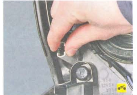
2. Поверните патрон против часовой стрелки на 90°...
