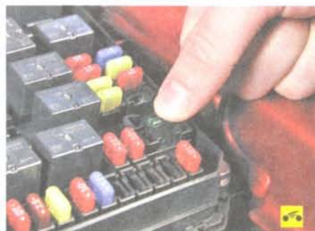
Рис. 10.2. Блок силовых предохранителей, размещенный на клемме «плюс» аккумуляторной батареи
