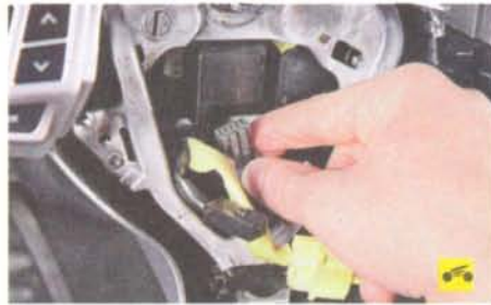
5. ...и отсоедините колодку от разъема рулевого колеса.
