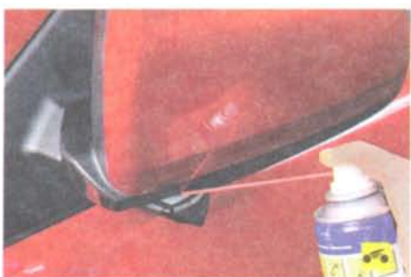
11. Петля и фиксатор крышки люка наливной горловины (силиконовая смазка или ВТВ-1 в аэрозольной упаковке).
