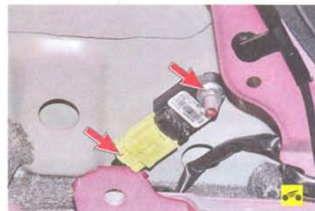
10. ...отсоедините колодку жгута проводов от разъема датчика, отверните гайку крепления датчика к стойке кузова и снимите датчик.
