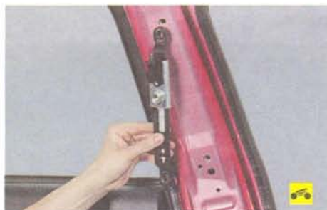
12. Выверните два болта крепления узла для регулировки положения ремня по высоте...
