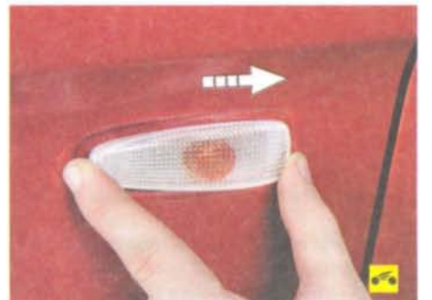
1. Сдвиньте боковой указатель поворота и выньте его из посадочного места.
