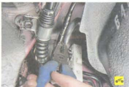
22. Ослабьте хомут крепления шланга системы улавливания паров топлива, сжав пассатижами его отогнутые ушки, сдвиньте хомут по шлангу...
