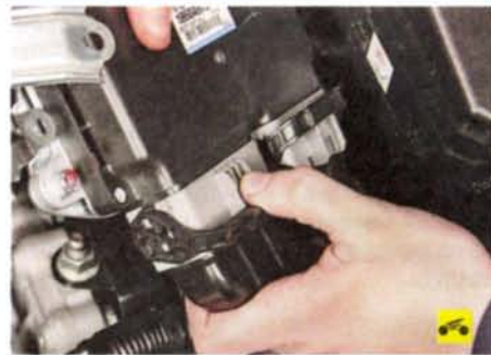
7. Поверните вниз скобу фиксатора колодки жгута проводов...
