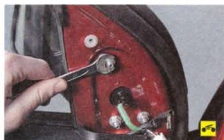
5. Отверните три гайки шпилек крепления зеркала к двери...
