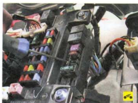
Рис. 10.3. Монтажный блок, расположенный в салоне автомобиля
