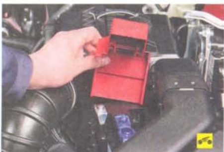
5. ...и снимите защитную крышку.
