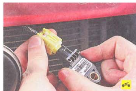
6. ...и отсоедините колодку от разъема датчика удара.
