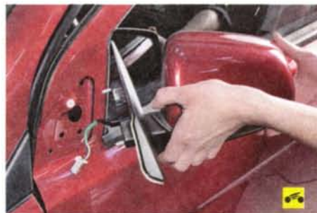
6. ...и снимите наружное зеркало заднего вида с автомобиля.
