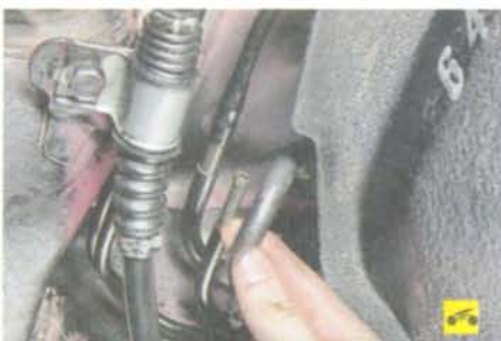
23. ...и отсоедините шланг от трубки паропровода.
