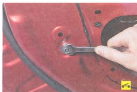
7. Выверните болт крепления направляющей стеклоподъемника к панели двери...
