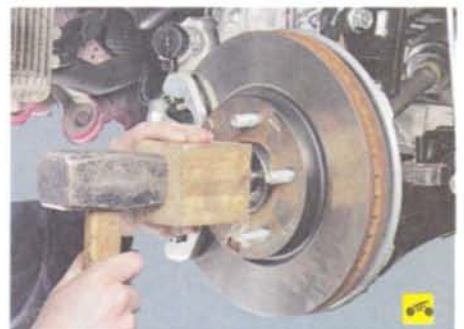
9. Отсоедините рулевую тягу от рычага поворотного кулака (см. «Замена наружного наконечника рулевой тяги», с. 159).
