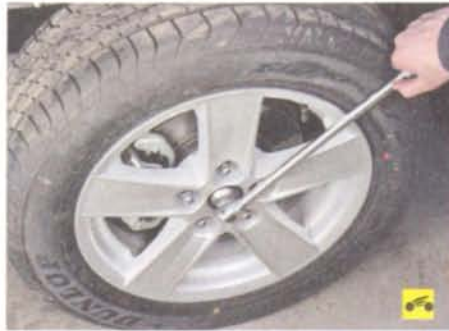
7. Ослабьте затяжку гайки ступицы переднего колеса.
