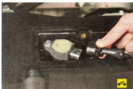
5. ...и отсоедините колодку от разъема катушки. Аналогично отсоедините колодки жгутов проводов от других катушек зажигания.
