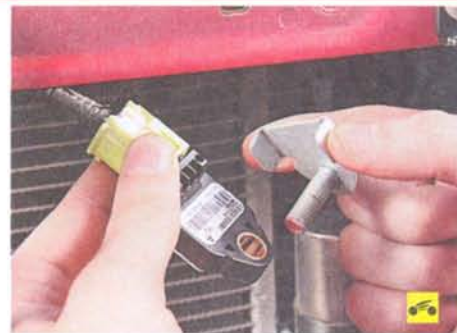
4. ...снимите с датчика скобу его крепления...
