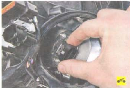
7. Вставьте новую лампу в отражатель и зафиксируйте ее, повернув на 90° по часовой стрелке.
