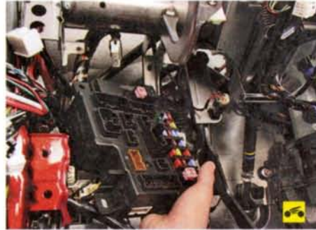
10. ...и снимите блок. 11. Установите монтажный блок и все снятые детали в порядке, обратном снятию.
