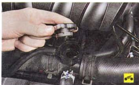
2. Уровень охлаждающей жидкости должен быть между метками «FULL» и «LOW», нанесенными на стенку расширительного бачка.
