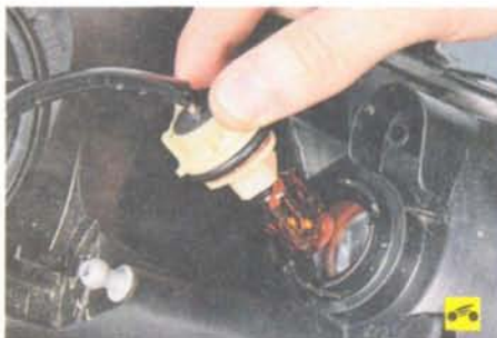
2. ...и выньте его вместе с лампой.
