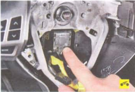
3. Снимите подушку безопасности водителя (см. «Снятие и установка подушки безопасности водителя», с. 266).
