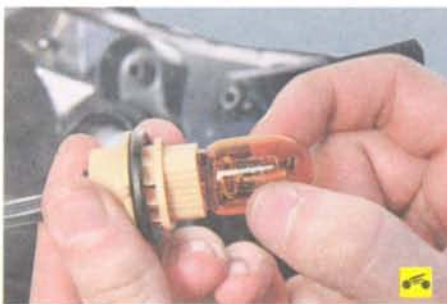
2. ...и выньте его вместе с лампой.
