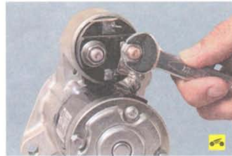
1. Отверните гайку на правом контактном болту тягового реле...
