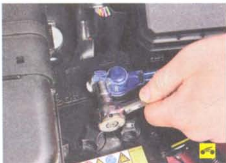
2. Ослабьте затяжку гайки стяжного болта наконечника «массового» провода...
