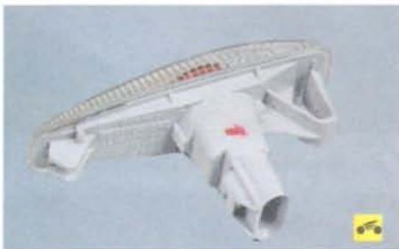
2. Поверните патрон лампы стоп-сигнала и габаритного огня против часовой стрелки...
