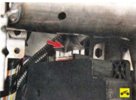
8. ...отведите блок вниз, чтобы получить доступ к верхней колодке жгута проводов...
