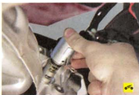
9. ...и выньте клапан из головки блока цилиндров.
