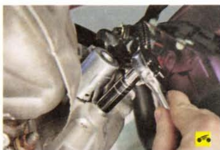
8. Выверните болт крепления управляющего клапана выпускного распределительного вала...
