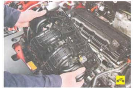
8. Снимите впускной коллектор двигателя (см. «Замена прокладки впускного коллектора», с. 94).
