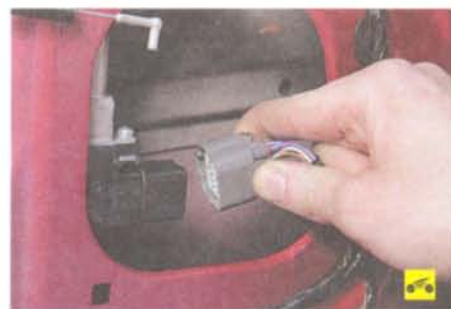
3. ...отсоедините колодку жгута проводов от разъема моторредуктора стеклоподъемника.
