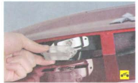
2. Снимите рассеиватель плафона...
