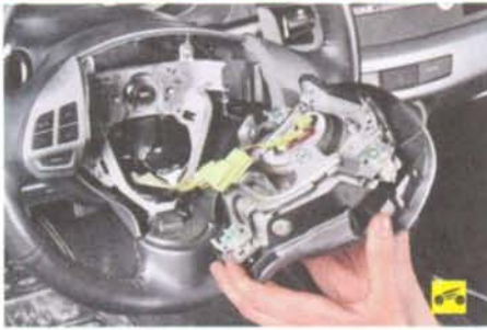
3. Снимите подушку безопасности водителя (см. «Снятие и установка подушки безопасности водителя», с. 266).
