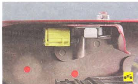
4. ...снимите с датчика скобу его крепления...
