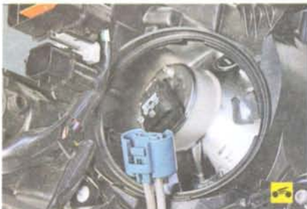
4. ...отсоедините колодку с проводами от выводов лампы дальнего света.
