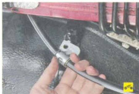
28. ...и снимите держатель со шпильки левого кронштейна крепления топливного бака.
