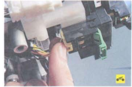
17. Нажмите на основной фиксатор желтой колодки...
