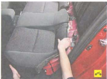
1. Преодолевая сопротивление защелок, снимите подушку заднего сиденья.
