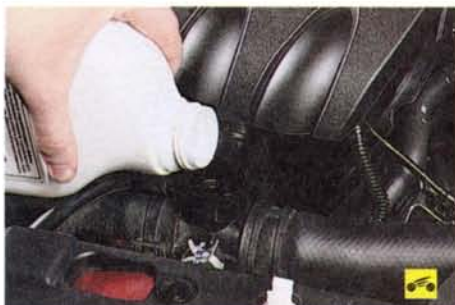
3. Если уровень охлаждающей жидкости ниже метки «LOW», потяните вверх за выступ...
