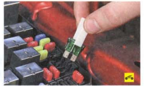
5. Зацепите пинцетом предохранитель...
