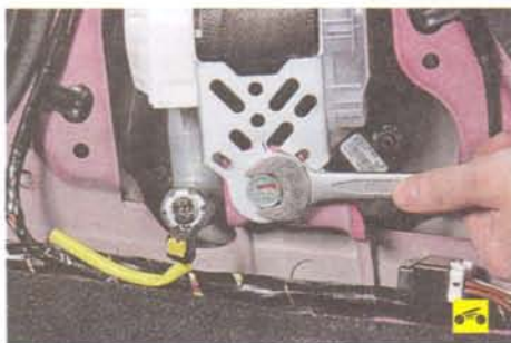
10. ...и нижний болты крепления инерционной катушки...
