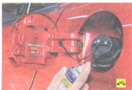
11. Петля и фиксатор крышки люка наливной горловины (силиконовая смазка или ВТВ-1 в аэрозольной упаковке).
