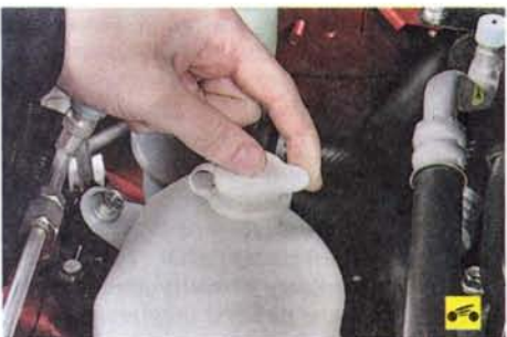
3. Если уровень охлаждающей жидкости ниже метки «LOW», потяните вверх за выступ...
