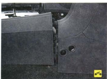
15. ...приподнимите облицовку, выведите ее крюки из зацепления...
