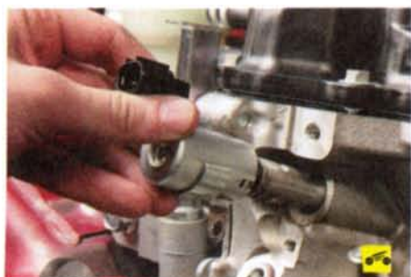
5. ...и выньте клапан из головки блока цилиндров.
