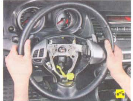
7. Резкими ударами рук сбейте рулевое колесо со шлицев вала...
