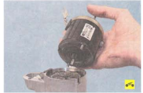
6. ...и разъедините статор и крышку со стороны привода.
