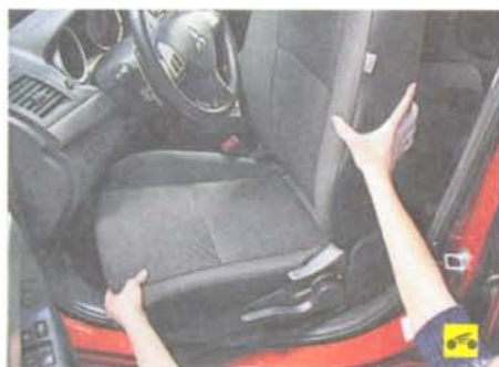
9. ...а затем, слегка развернув сиденье, выньте его из салона автомобиля.
