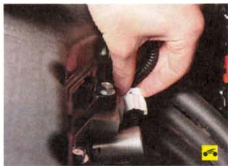
2. Нажмите на пружинный фиксатор...
