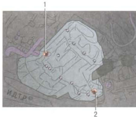
Рис. 4.4. Расположение пробок наливного и сливного отверстий механической коробки передач: 1 – пробка наливного отверстия; 2 – пробка сливного отверстия
