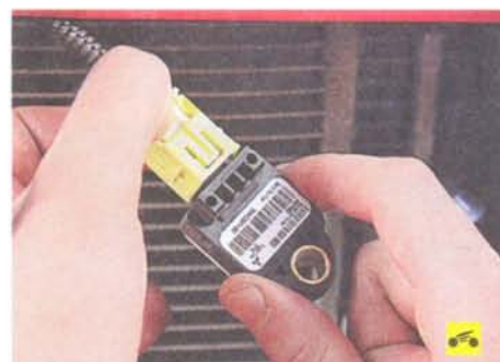
5. ...сожмите фиксатор колодки жгута проводов...
