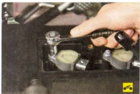
6. Выверните болт крепления катушки зажигания к крышке головки блока цилиндров...
