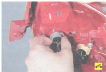
2. Поверните патрон лампы стоп-сигнала и габаритного огня против часовой стрелки...
