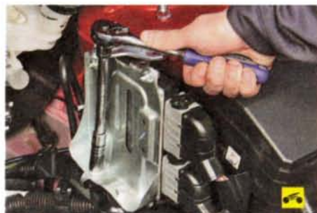
4. ...и два болта крепления кронштейна к кронштейну воздушного фильтра.
