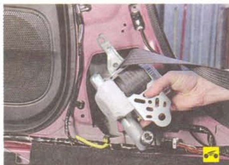
11. ...и извлеките ее из стойки кузова.
