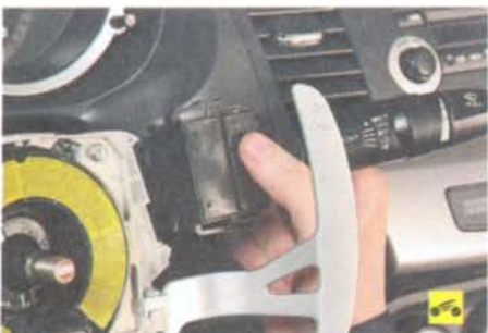
9. ...извлеките переключатель из соединителя и отсоедините от него колодку жгута проводов.
