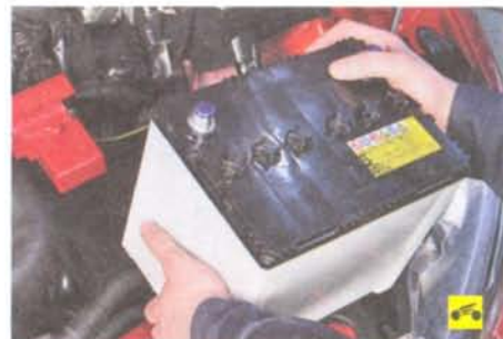
12. Снимите аккумуляторную батарею с автомобиля.
