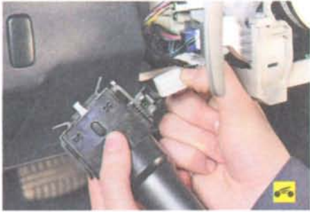
7. ...и отсоедините колодку от разъема переключателя.
