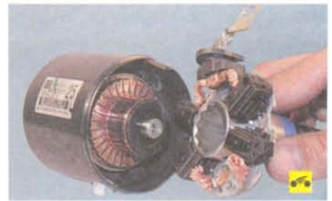
9. Снимите щеткодержатель с якоря. Для облегчения последующей сборки рекомендуется при снятии щеткодержателя сразу же зафиксировать в нем щетки, сдвигая щеткодержатель на головку подходящего диаметра из набора инструментов.
