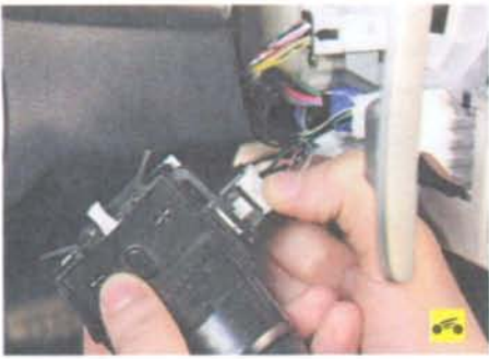
6. Отожмите фиксатор колодки жгута проводов левого переключателя...
