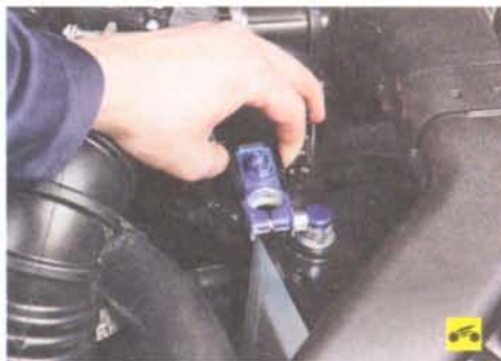
7. ...и отсоедините провод от клеммы «плюс» батареи.
