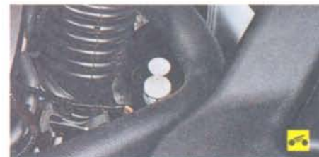
Рис. 4.4. Расположение пробок наливного и сливного отверстий механической коробки передач: 1 – пробка наливного отверстия; 2 – пробка сливного отверстия
