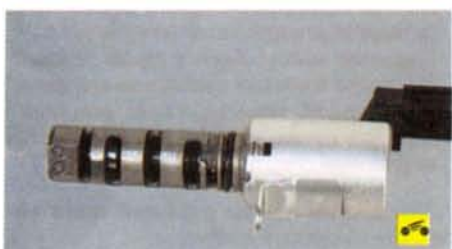
5. ...и выньте клапан из головки блока цилиндров.
