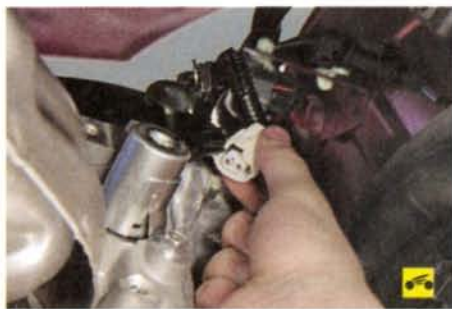
7. Нажмите на пружинный фиксатор и отсоедините колодку жгута проводов от управляющего клапана механизма изменения фаз выпускного распределительного вала.
