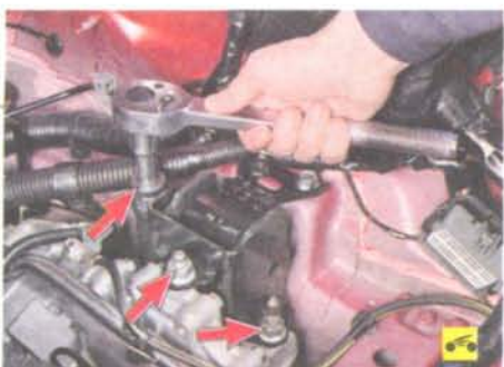
9. Отверните три гайки шпилек крепления кронштейна опоры к коробке передач...
