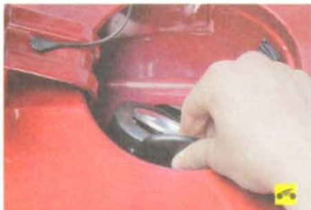
18. Протолкните уплотнитель горловины наливной трубы в отверстие лючка...
