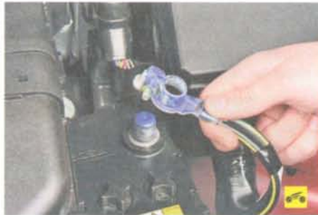
3. Отсоедините провод от клеммы «минус» аккумуляторной батареи
