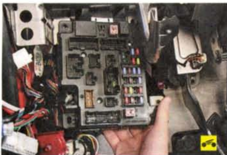
8. ...отведите блок вниз, чтобы получить доступ к верхней колодке жгута проводов...
