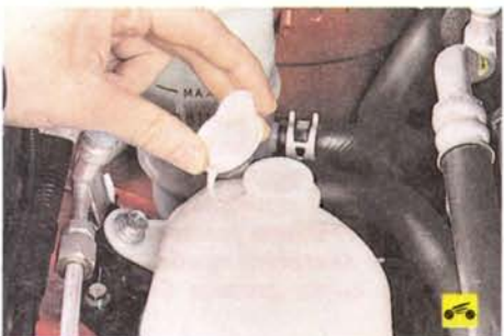
4. ...и откройте крышку расширительного бачка.
