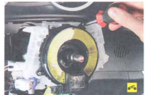
19. Выверните два винта крепления контактного кольца к соединителю подрулевых переключателей...
