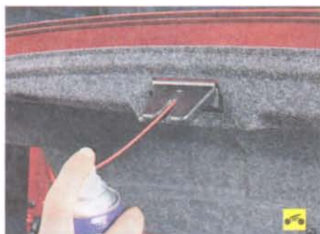
9. ...и защелка замка крышки багажника (силиконовая смазка или ВТВ-1 в аэрозольной упаковке).
