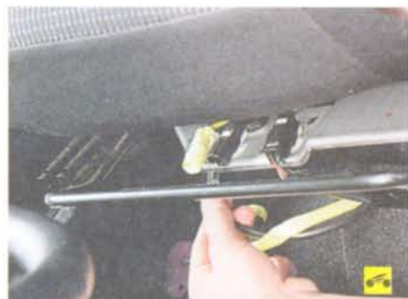
7. ...колодку жгута проводов обогрева сиденья...
