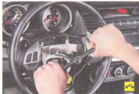
5. ...и отсоедините колодку от разъема рулевого колеса.
